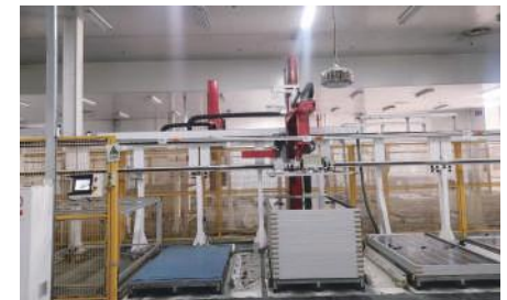
◆ J4200BK系列用于桁架机械手搬运，行程22米
